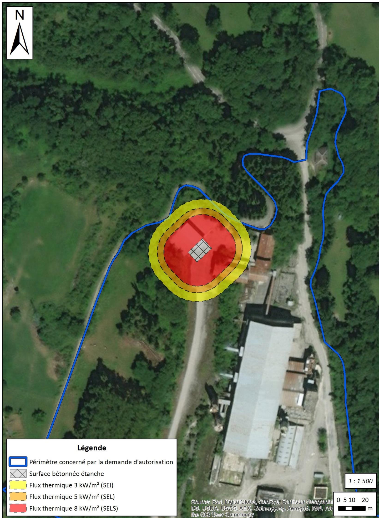
Figure 5 – Rayonnement émis par un feu de nappe au niveau de la zone de ravitaillement des engins
